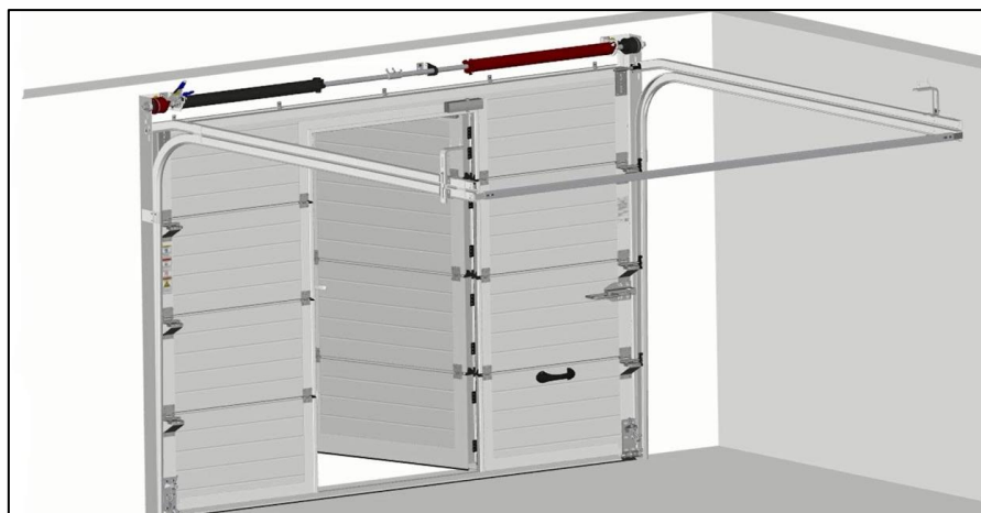
Figure 4- Schéma porte sectionnelle type (non contractuel) – hublots non représentés
